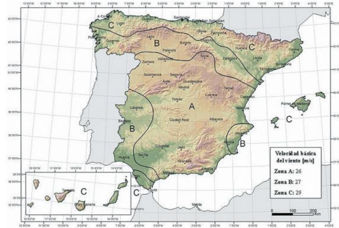
Figura 1. Mapa de isotacas para la obtención de la velocidad básica fundamental del viento.
