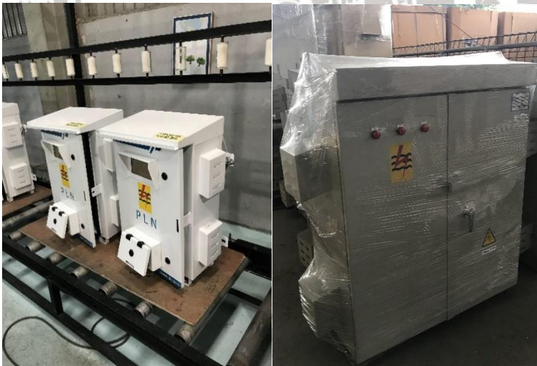
Gambar 4.2 Produk panel tegangan rendah - pasar PLN Sumber: Data perusahaan PT. Pura Mayungan
