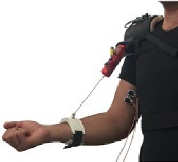
図 2.10 TSA モジュールを用いた装着型デバイス[47]
