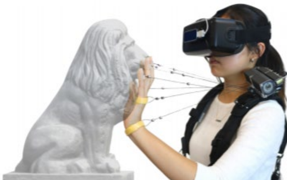
図 2.7 糸を巻き取る手法を用いた装着型デバイス[39]
