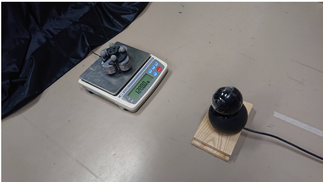
図 4.6 糸の牽引方向を確認するための Web カメラ
