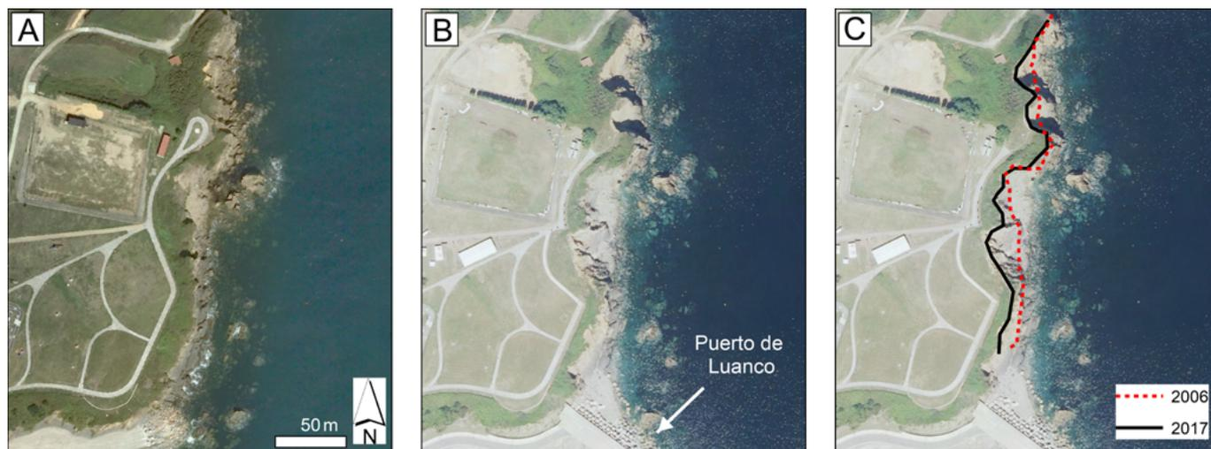
**Fig. 3.- Acantilado al norte de Luanco. A) Ortofotografía de 2006. B) Ortofotografía de 2017. C) Posición de la línea de acantilado activo en 2006 y 2017, respectivamente, sobre la ortofoto de 2017. Ver figura en color en la web.**
