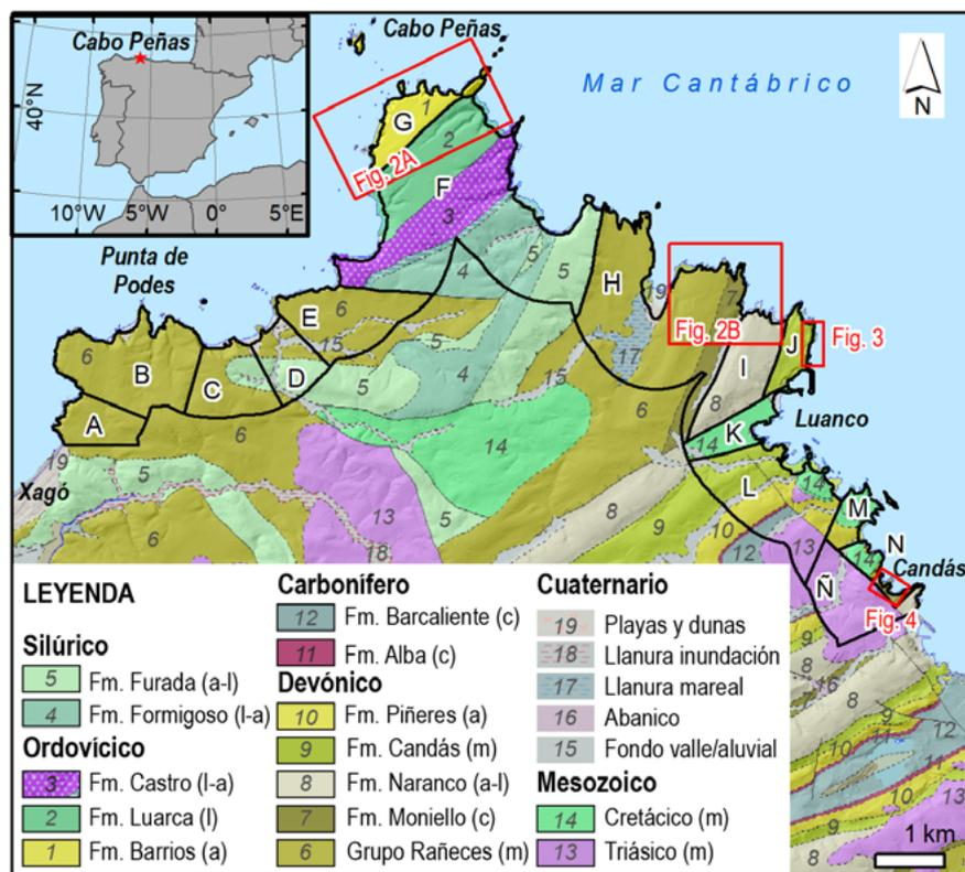
**Fig. 1.- Mapa geológico de la zona de estudio con indicación de los 15 tramos de costa (A-Ñ) diferenciados. Clave litológica: a, areniscas; l, lutitas; c, carbonatos (calizas, margas, dolomías); m, mixtas (carbonatos + lutitas). Ver figura en color en la web.**
