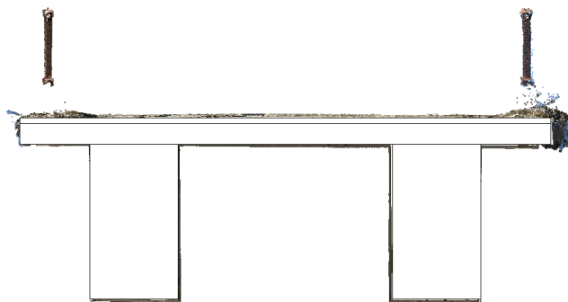
Figura 88-Sobreposição entre o modelo BIM e o levantamento laser scanning ao nível da secção transversal da ponte
