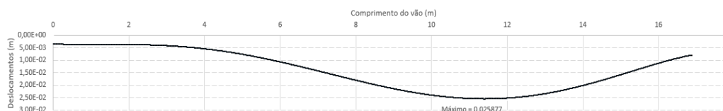
Figura 47-Deformada analítica com recurso a Excel (0.0259m) [m]
