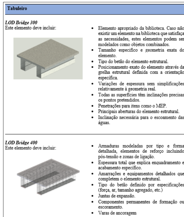
Figura 77-LOD Bridge 300 e LOD Bridge 400 para um tabuleiro
