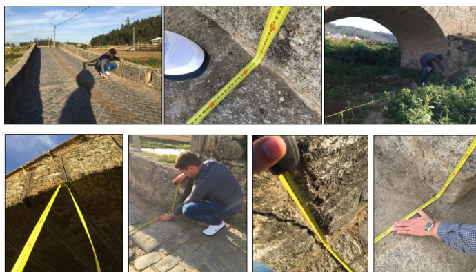
Figura 61-Levantamento com fita métrica de medidas da ponte medieval em Arcos
