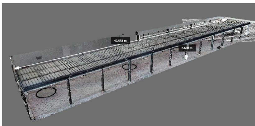
Figura 49-Nuvem de pontos em software RECAP captada com ScanStation P40 [m]
