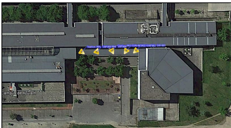
Figura 48-Estacionamentos do 'laser scanner' dos quais se procedeu ao levantamento na Universidade do Minho
