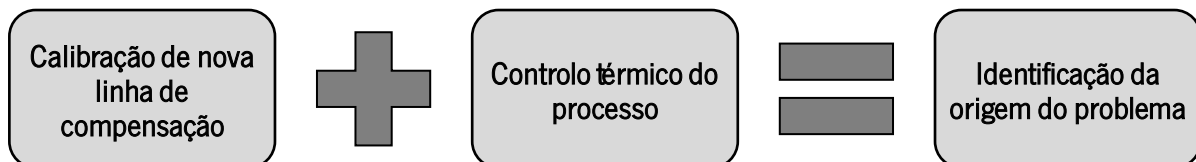
Figura 33 – Etapas adotadas para a identificação da origem do defeito ocorrido.
