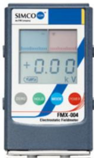
Figura 27 – Medidor de campo eletrostático SIMCO FMX-004.
