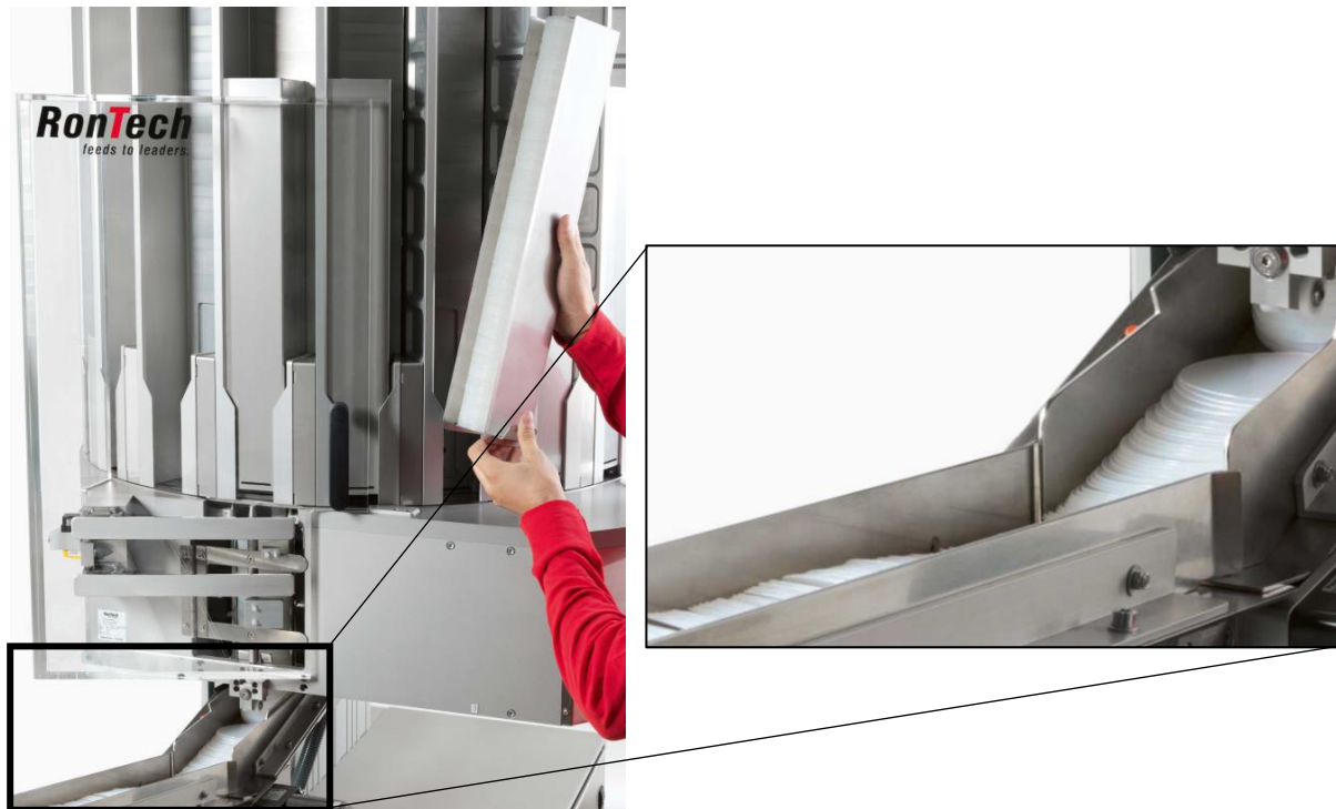
Figura 5 – Zona do “buffer” (empilhamento) e zona de entrada, ampliada na imagem à direita.
