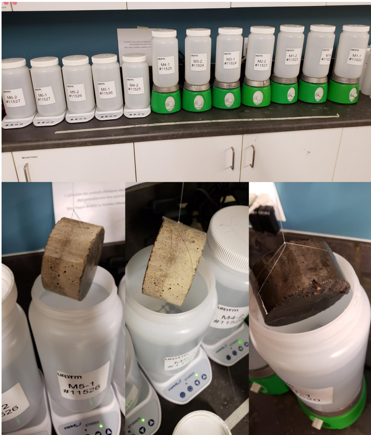
Figure B.2. Test de lixiviation en monolithe
