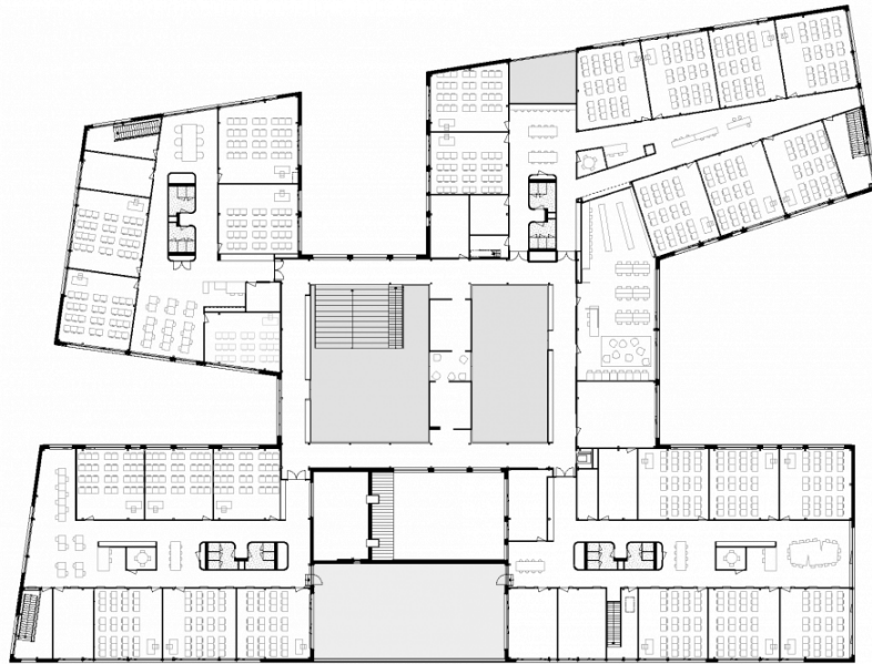
Figuur 5. De 1 e verdieping van het Strabrecht College in Geldrop. Domeinen binnen de school zijn gecompartmenteerd in verschillende bouwdelen. De centrale hal met veel mogelijkheden naar buiten te gaan en de 8 die men kan lopen in de bouwdelen. Bron: atelier PRO architecten.
