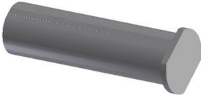
Figura 9 – Corpo de Prova Identado.
