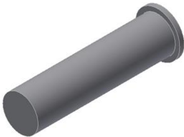
Figura 7 – Corpo de Prova segundo a Norma ASTM A255.
