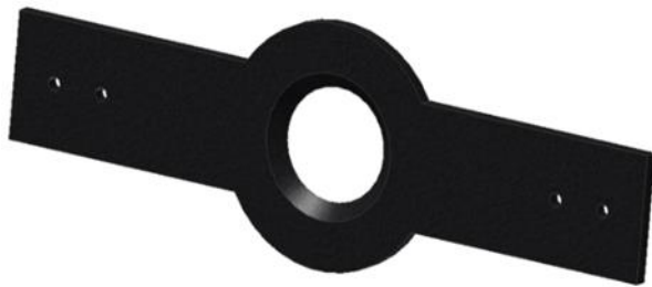
Figura 3 – Suporte para o corpo de prova.
