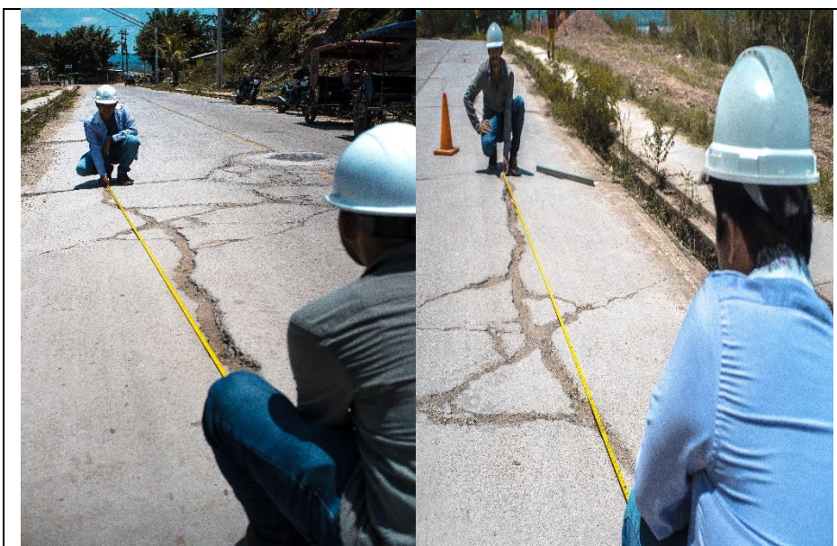
Foto 20: Realizando la respectiva medición del daño de losa dividida en el Jr. Arica C-1 para evaluar su severidad.
