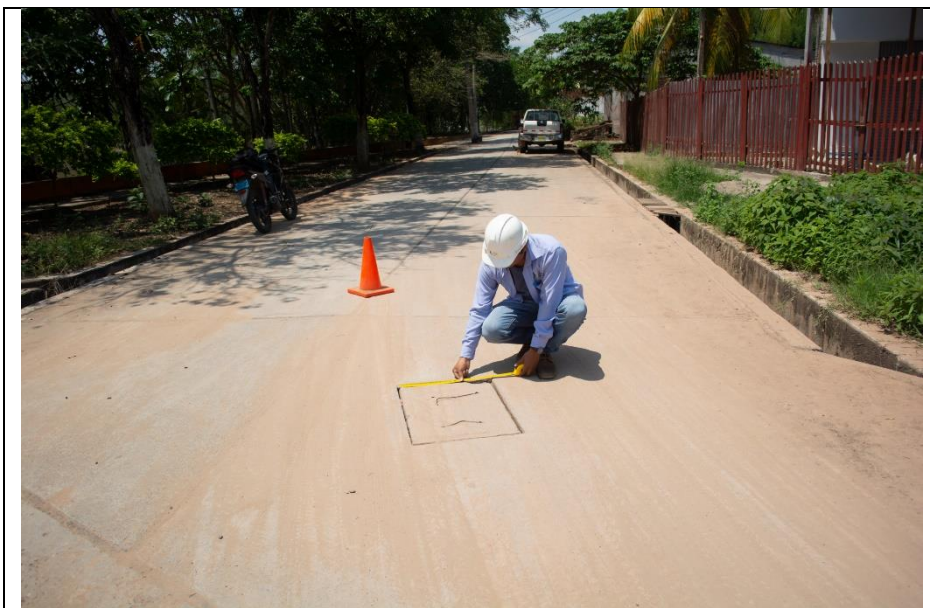
Foto 13: Realizando la medición del daño de parcheo grande en el Jr. Malecon C-6.
