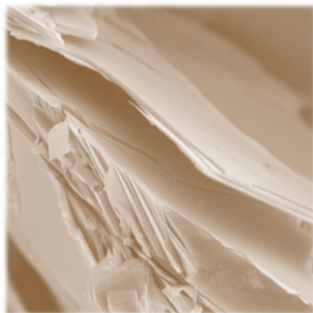
Рисунок 2. Микроструктура скола прекурсора-пластинки (а), наноразмерная слоистая структура кристаллита-зародыша (b).
