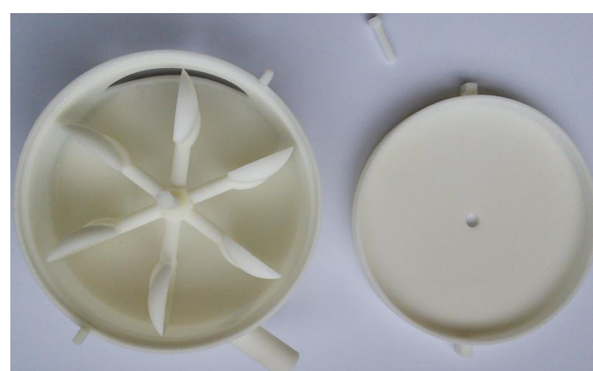
(d) Structure of a water turbine
