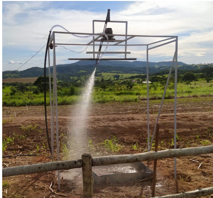
Figura 1. Simulador de chuvas pendular construído no IF Goiano Campus Iporá e utilizado para os testes de escoamento superficial e qualidade da água escoada em diferentes coberturas do solo para uma área de amostragem igual a 1m 2 .
