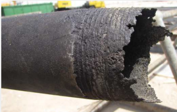
Figura II.16 Fallo de acoplamiento de pernos y caja debido a la presencia de gas H 2 S (1,000 ppm) y 2% de CO 2
