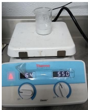
Figura 15. Disolución de los precursores para la fabricación de polvos BBO y polvos BBO dopados con iones \text{Ag}^+ , \text{Tb}^{3+} y \text{Mn}^{2+} .
