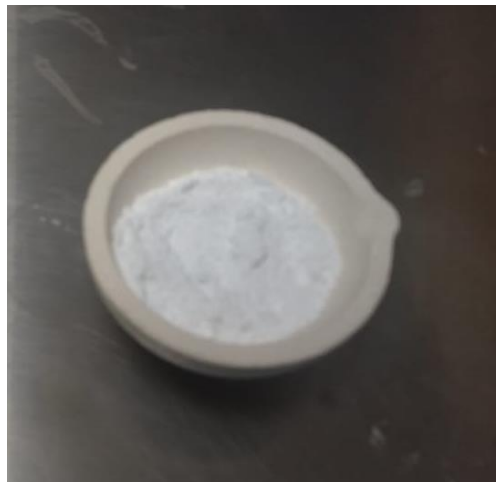
Figura 19. Polvo depositado en la copela cerámica.
