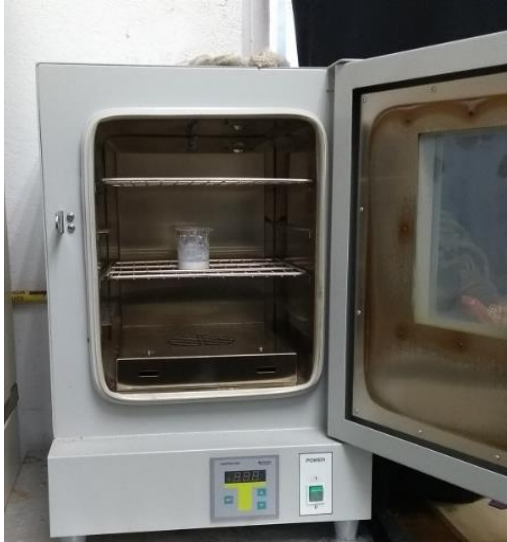
Figura 17. Solución de borato de Bario, dopado con iones \text{Ag}^+ , \text{Tb}^{3+} y \text{Mn}^{2+} , en el proceso de desecado.
