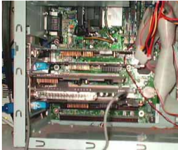
Figura 5.6 Tarjetas VGA y WinTV instaladas
