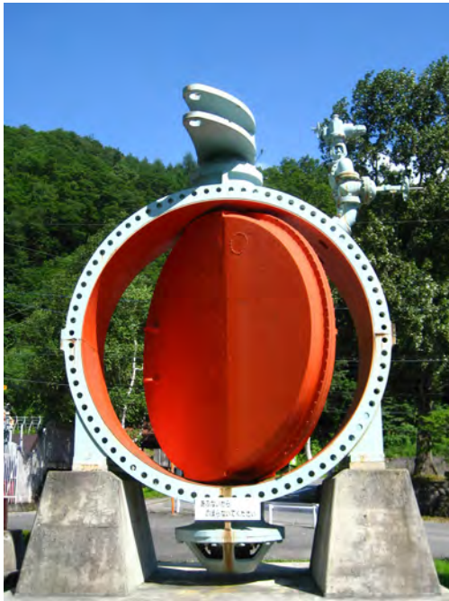
Рис. 4. Крупный затвор с плоскоскошенным диском, использовавшийся на гидроэлектростанции в Японии [1; 2]. [Электронный ресурс]: https://commons.wikimedia.org/wiki/File:Yagisawa_power_station_inlet_valve.jpg?uselang=ru . Доступ 22.07.2019.
