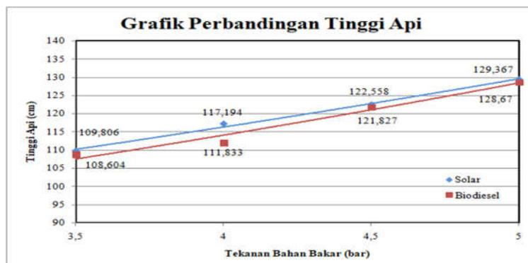
Gambar 4. Perbandingan antara tekanan bahan bakar solar dan biodiesel minyak jelantah dengan tinggi api hasil pembakaran.
