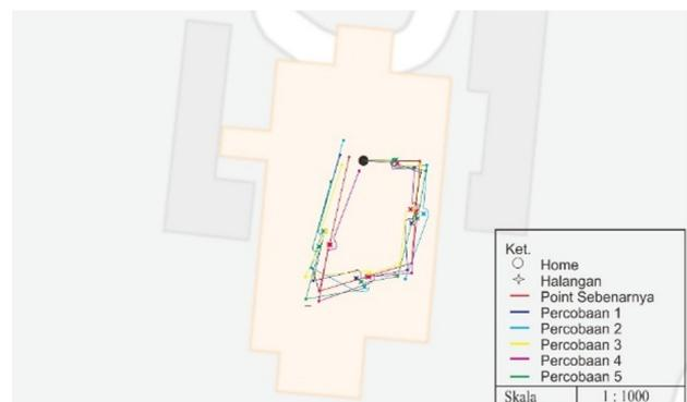
Gambar 13. Pengujian *waypoint* saat ada halangan atau lubang
