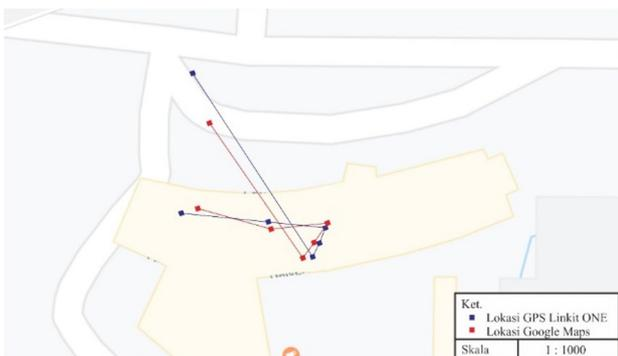
Gambar 9. Perbandingan data posisi GPS *Linkit ONE*
