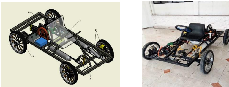
Gambar 2. Desain Mobil “hybrid BED 18” (kiri) dan mobil hasil rancangan (kanan).
