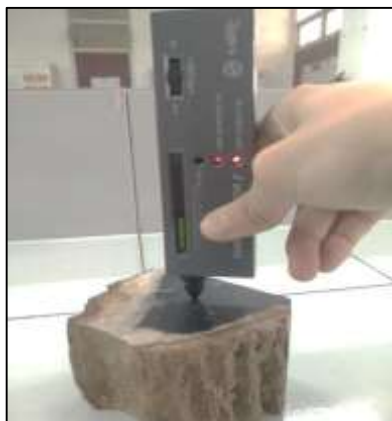
Gambar 2. Alat dan cara menentukan nilai kekerasan fossil kayu
