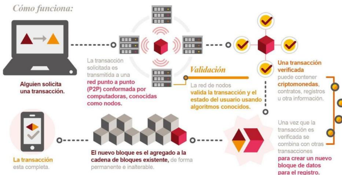
Figura 1.1: ¿Cómo funciona la tecnología Blockchain?
