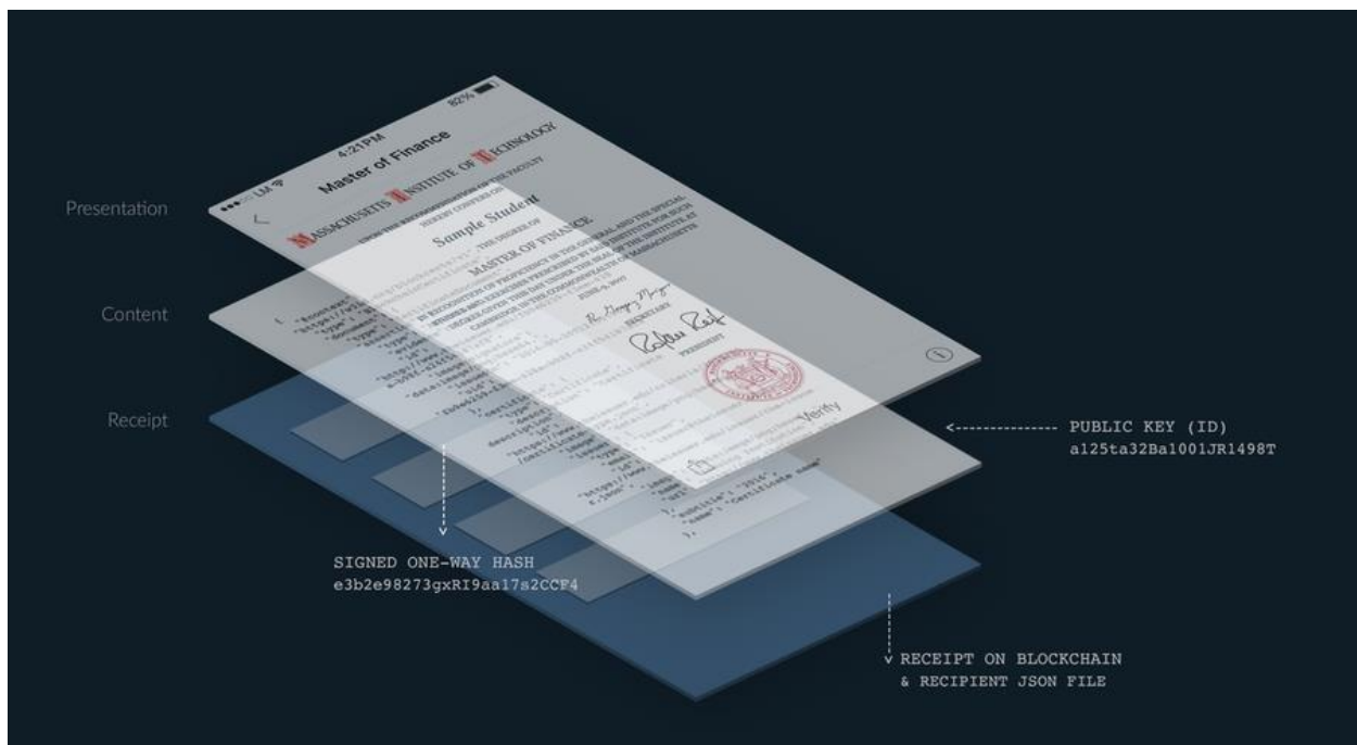
Figura 2.9: Capas de un Grado Académico emitido con el estándar Blockcerts
