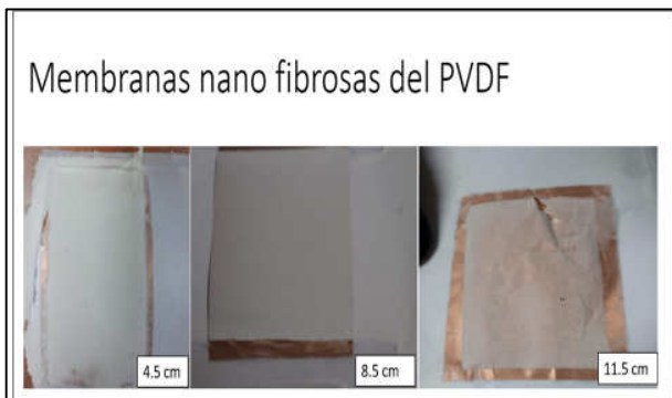
Figura 3. Resultados de la membrana nano fibrosas del PVDF con respecto a su distancia de separación.
