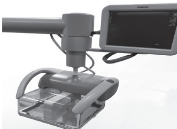
Фиг. 2. Апликатор с автоматично подвижен трансдюсер в него
