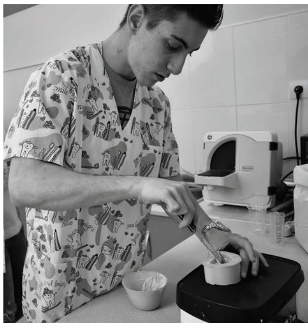
Фиг. 3. Изпълване на дублирания силиконов отпечатък с висококачествен твърд гипс върху вибромаса
