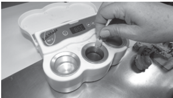
Фиг. 2. Щопване в електрическа ваничка с потопен восък
