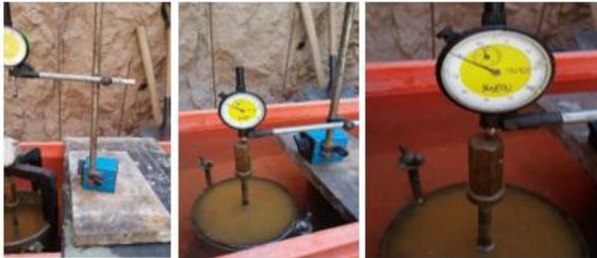
Figura 34. Colocación del soporte magnético con dial indicador universal.
