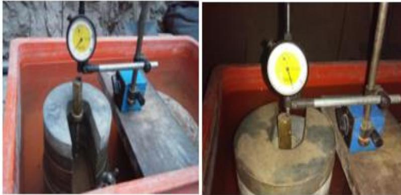
Figura 37. Registro de variaciones de la presión de contacto del dial.
