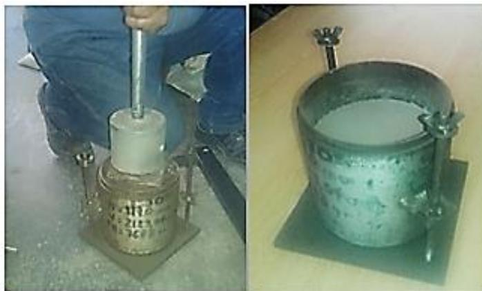
*Figura 29.* Muestra compactada del molde de CBR.
