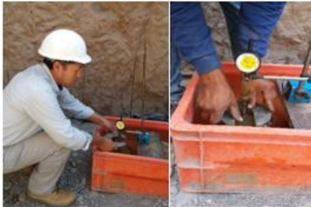
Figura 36. Colocación de las barras de acero en el molde del CBR.
