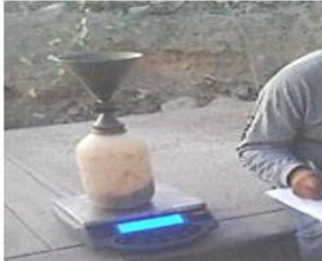
Figura 43. Pesando la arena calibrada extraída del hoyo in situ.
