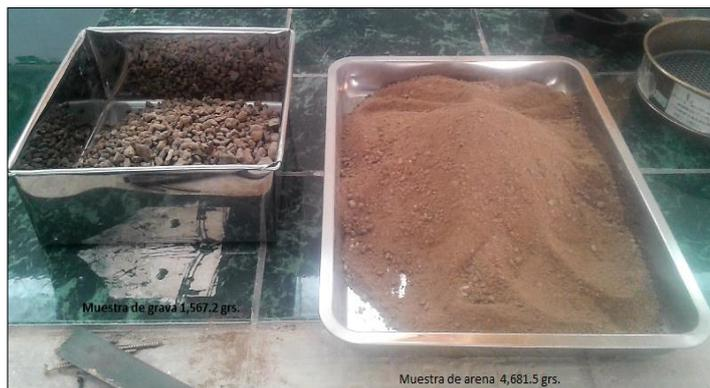
Figura 18. Muestra tamizado por el tamiz # 04.
