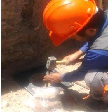
*Figura 41.* Excavación in situ para extraer la muestra de campo
