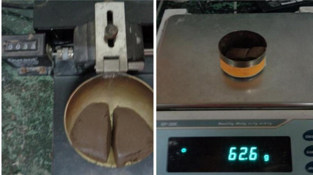
Figura 19. Presentación de muestra enrasa y separada en la copa casagrande.
