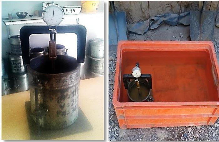
Figura 30. Muestra saturada de agua del molde de CBR.
