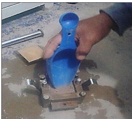
Figura 47. Muestra del suelo en la caja de corte.
