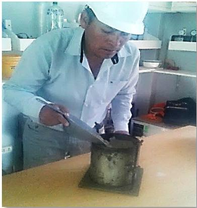
*Figura 28.* Muestra de campo del molde de CBR.
