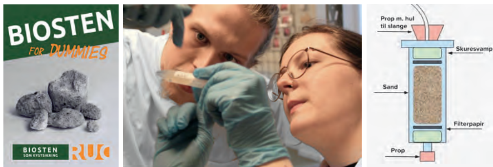
Illustration 1. Biosten som kystsikring. a) Billede af gruppens korte introduktionsguide til emnet, b) en prøve undersøges, c) diagram over det hjemmedesignede dyrknings- og forsøgs-kammer.
