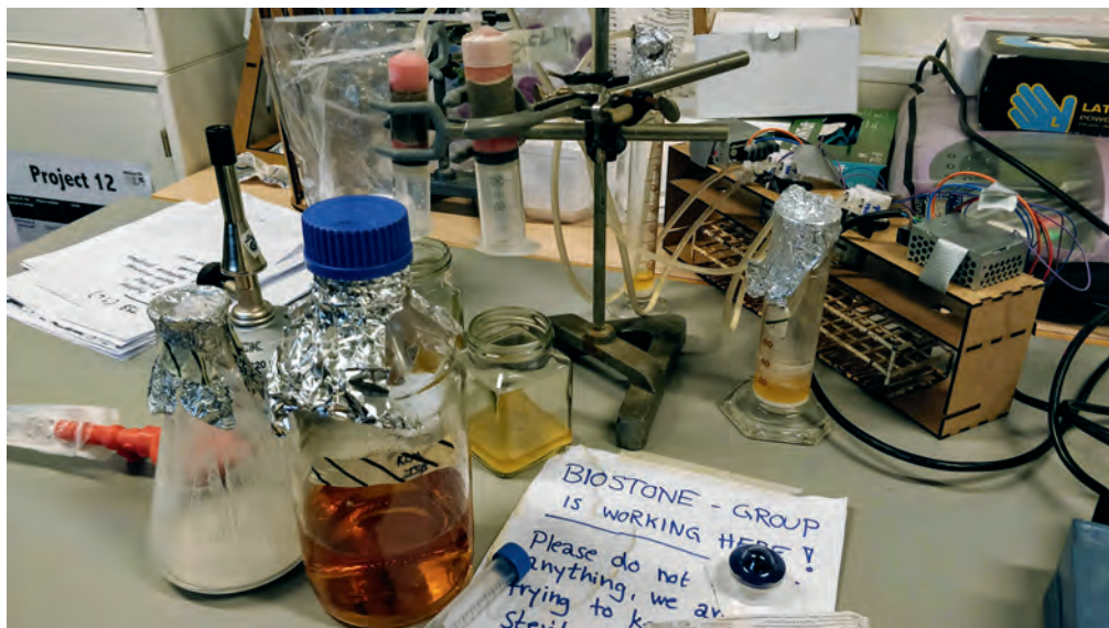
Illustration 2. Biostenforsøgsopstillingen. Laboratorieglass, engangssprøjter, syltetøjsglas og hjemmebygget elektronik.
