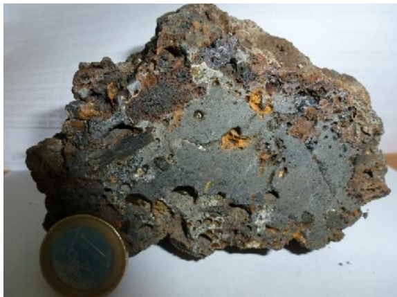
Obr. 2 Pohľad do vnútra rozpilenej trosky skládkovanej na odkalisku v Lintichu. Meteorická voda infiltrovaná cez otvorený priestor pórov spôsobila rozpúšťanie Pb, Zn, Cu sulfidov za vzniku roztoku H_2SO_4 a následne celkovej alterácie silikátovej trosky. Dekompozícia metastabilného silikátového skla a sulfidov uvoľňuje katióny Pb, Zn, Cu, As ďalej do prostredia.
