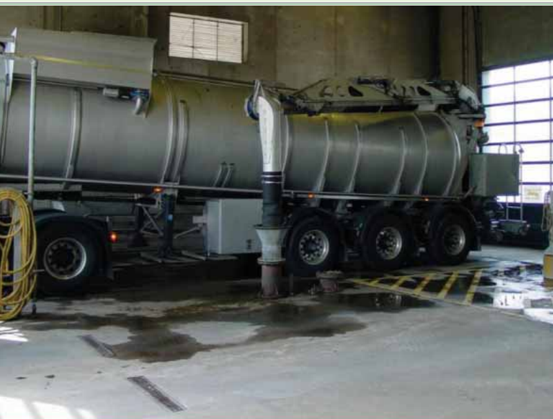
Figur 10: Aflæsning af flydende husdyrgødning via studs i aflæssehal på Lemvig biogas
