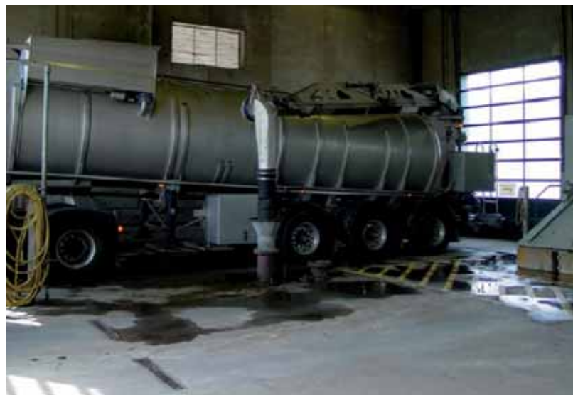
Figur 5: Aflæsning af flydende biomasse med tankbil i modtagehal
