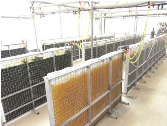
Figur 5. En fotobioreaktor af den høje smalle (laminære) type. Ben Gurion Universitetet, Sede Boqer, Israel. Eget fot.
