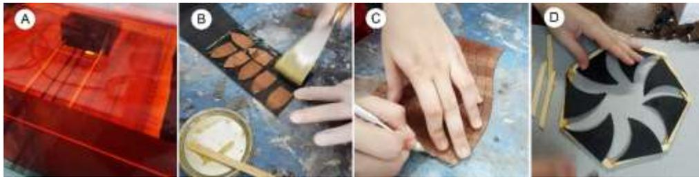
**Figura 11.** Etapas de montagem dos protótipos na oficina: corte a laser (Figura 12A); colagem da lâmina de madeira no alumínio (B); recorte do excesso de alumínio (C); montagem das partes de acordo com o projeto (D)..
