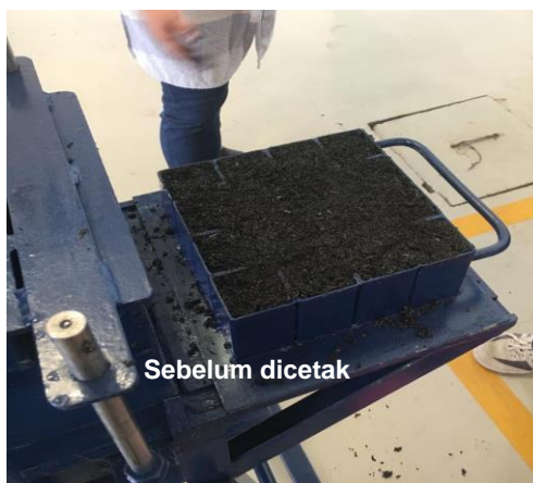
Gambar 9. Proses pencetakan briket arang sekam
