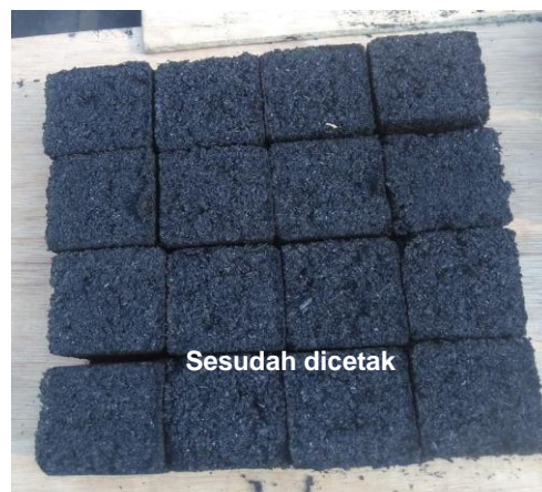
Gambar 9. Proses pencetakan briket arang sekam
