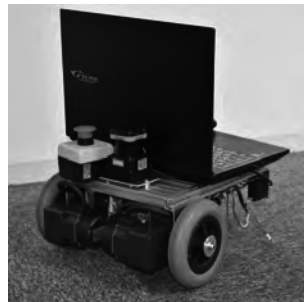
(a) i-Cart mini 移動ロボット台車 (非常停止スイッチ取付済)
