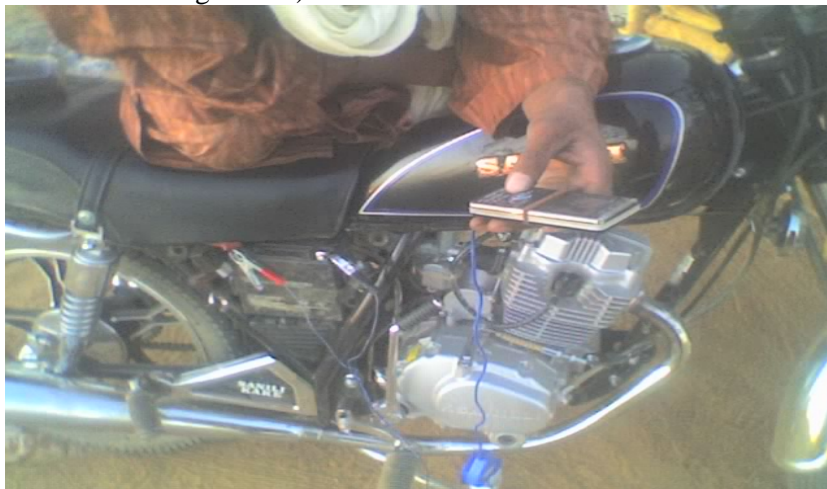
Photo 3.22 Exemple de recharge du téléphone à partir de la batterie d'une mobylette qui est en passe de remplacer le charmeau dans le déplacements quotidiens (cliché Youssouf Ag Rhissa)
