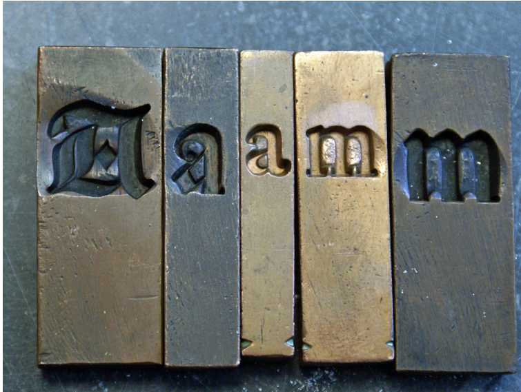
Figure 8.21 Matrices by Van den Keere of the Gros Canon Romain and the Canon d’Espagne.
