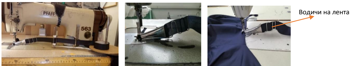
Слика 2. Нашивање на паспул со апарат
