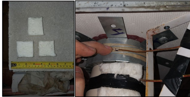
Figura 13 – À esquerda: manta cerâmica de 96 kg/m 3 utilizada para revestir o ponto de contato dos termopares. À direita: colocação do termopar 02.
