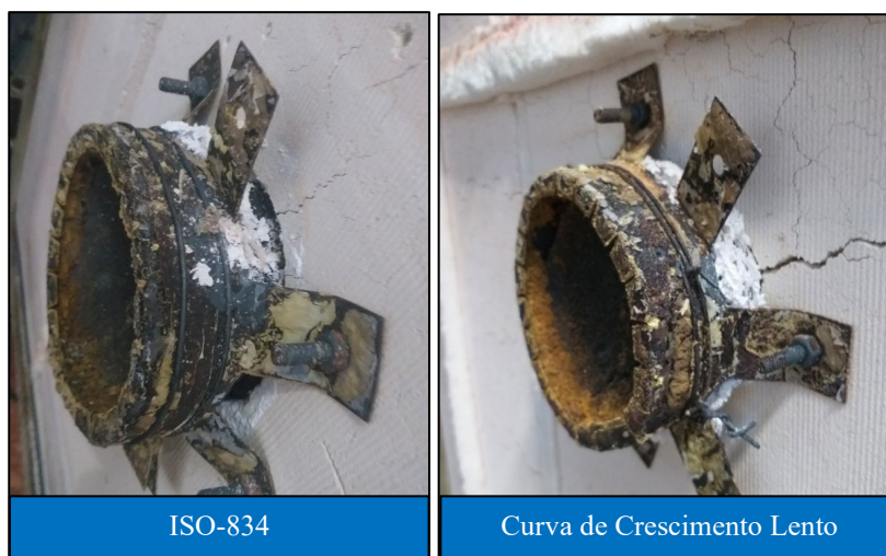
Figura 15 – Fotografias das faces quentes após ensaio. À esquerda: ensaio com a ISO-834. À direita: ensaio com a Curva de Crescimento Lento.
