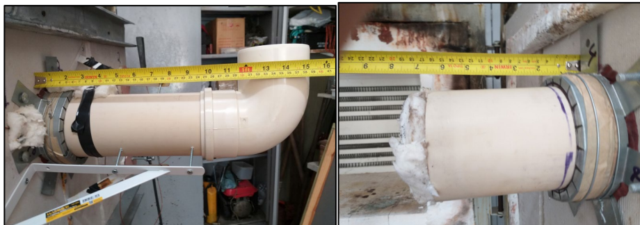
Figura 14 – À esquerda: face não exposta ao fogo do sistema de selagem. Foi colocado três pontos de fixação da tubulação para que não tenha movimentação durante o ensaio. À direita: face exposta ao fogo.
