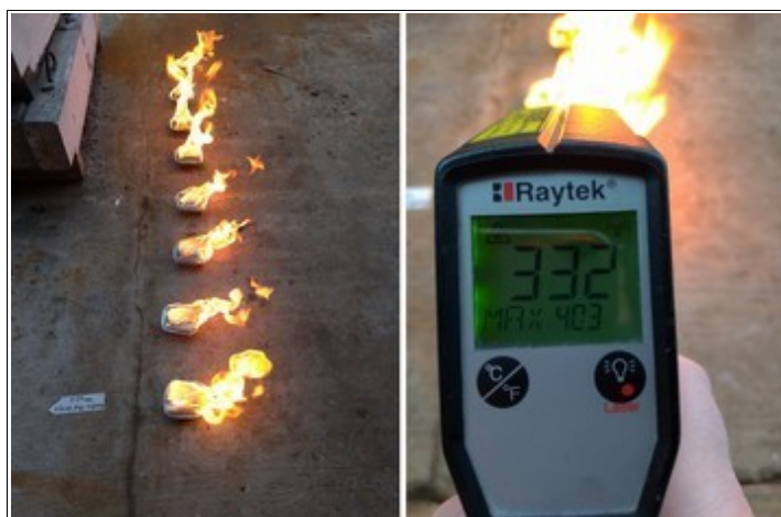
Figura 9: amostras com espuma após ignição e medição da temperatura.
