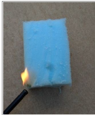
Figura 5: ignição de amostra com utilização de acendedor e sem acelerante de combustão adicionado.
