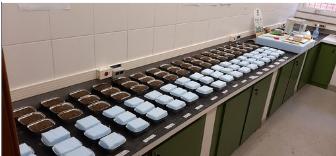
Figura 12: amostras de solo e espuma distribuídas antes da queima.
