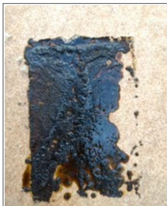
Figura 7: remanescentes após queima total da espuma.
