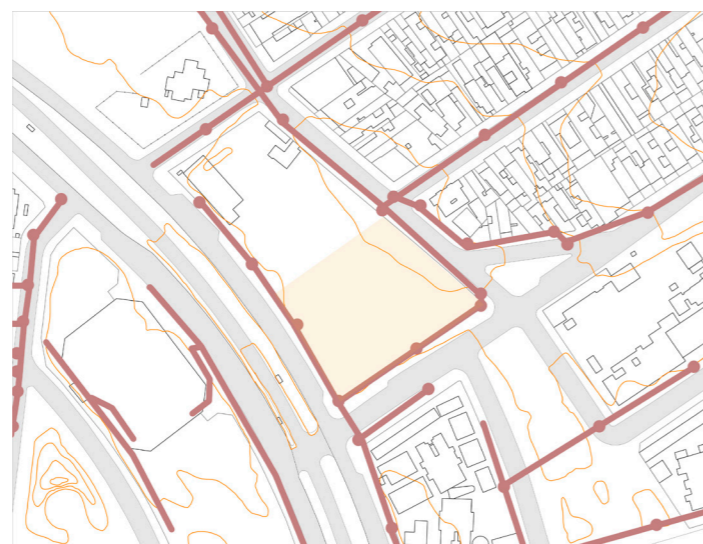
● poço de visita — dutos de esgoto cloacal
