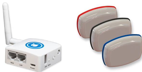
Figura 11: Leitor Bluecats modelo Edge (Esquerda) e Tags (Direita)
