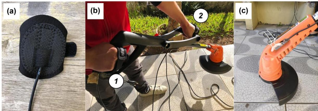
Figura 6 - Sistema desenvolvido para medições em campo. (a) protetor palmar com acelerômetro acoplado na região da palma da mão; (b) protetor palmar na mão de acionamento (1) e na mão de sustentação (2); (c) acelerômetro fixado próximo à região do motor do aparador de grama. (Fonte: Autoria própria)
