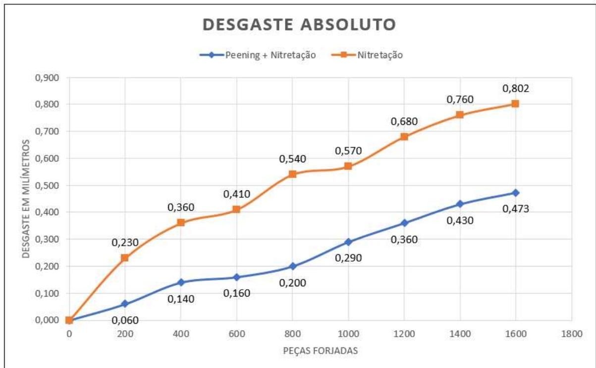
Figura 61 - Perfil de desgaste absoluto, comparativo do efeito do processo de *shot peening*.
