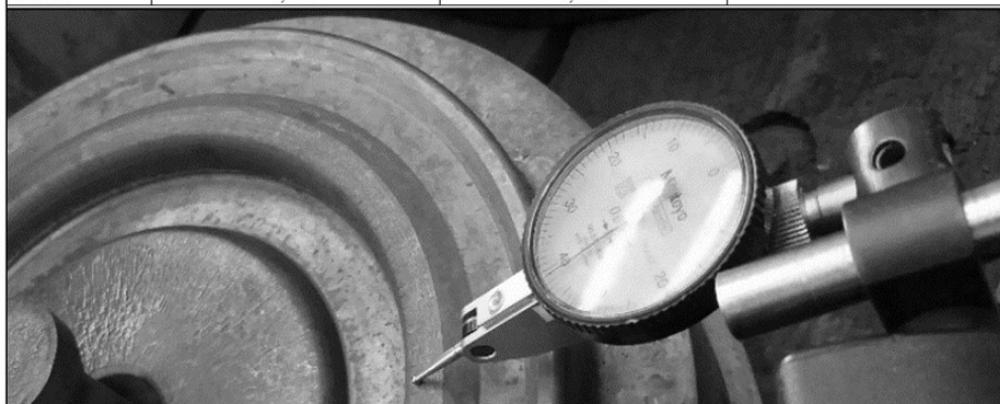
Figura 64 - Medição do desgaste total na matriz de forjamento.
