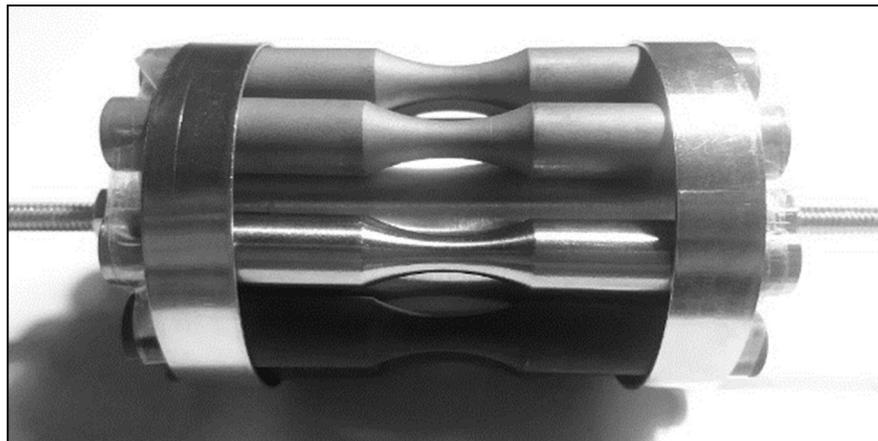
Figura 43 - Arranjo de montagem dos corpos de prova no rolo rotativo.
