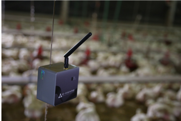
Figura 1.2: Sensor de dados microclimáticos utilizado em aviários. Fonte: (SISTEMA..., 2020)
