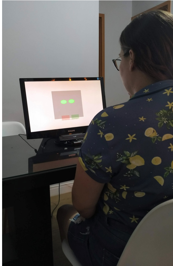
Figura 5.1: Primeira etapa da calibragem, onde é calculada a distância entre o usuário e o eye-tracker.
