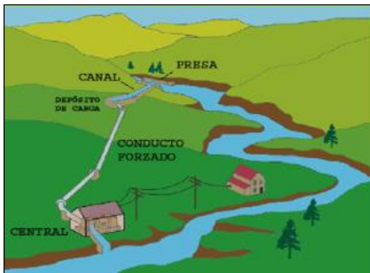
Ilustración 17. Esquema general de una PCH.
