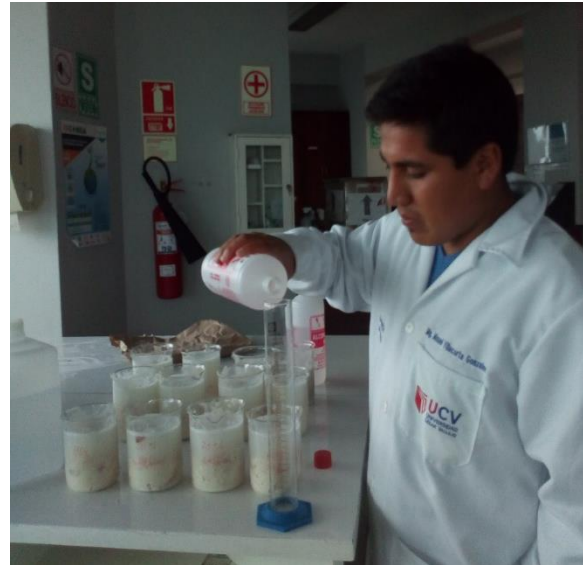
Figura 7. Preparando las concentraciones de etanol para la maceración y extracción de Saponinas.
