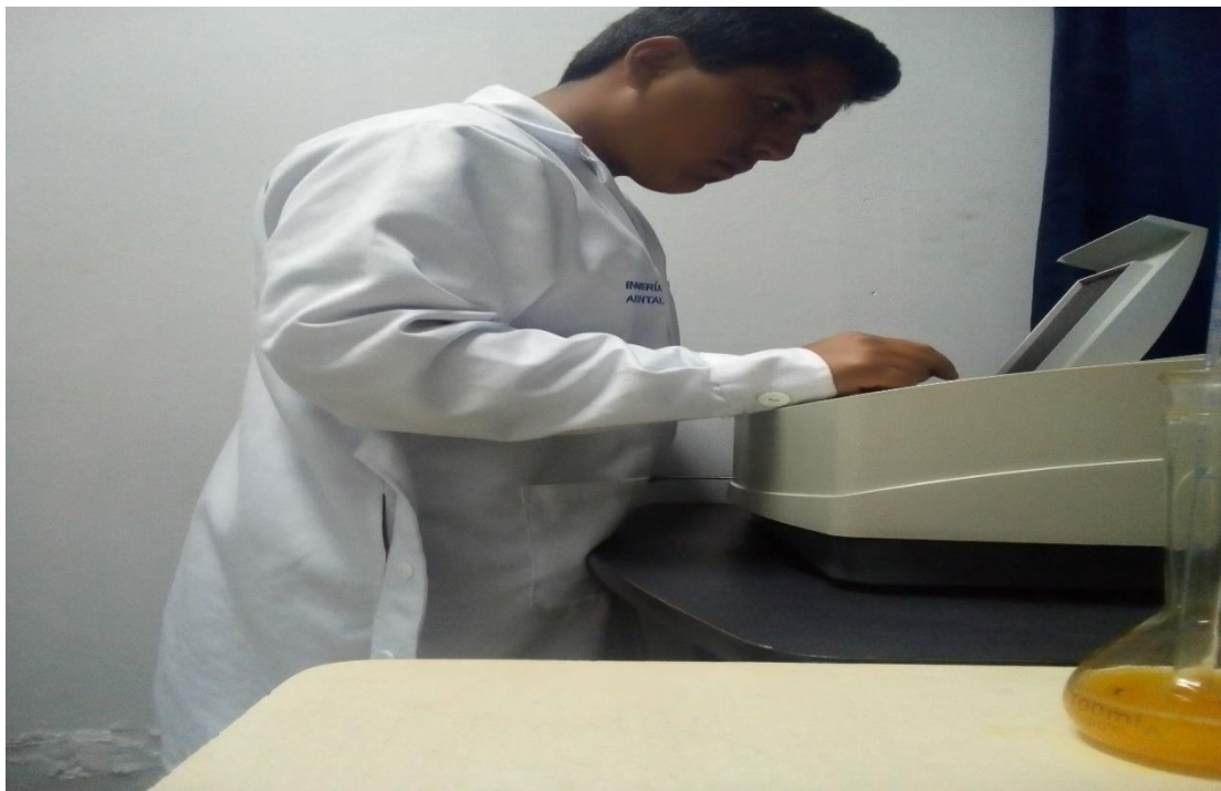
Figura 11. Medición de Saponinas en el espectrofotómetro en el espectrofotómetro.
