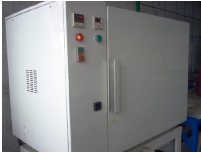
Figura 4. Estufa de circulación forzada (Marca MLW), con capacidad hasta 200°C, control de temperatura automática y digital y control de tiempo en horas, capacidad 4 bandejas.
