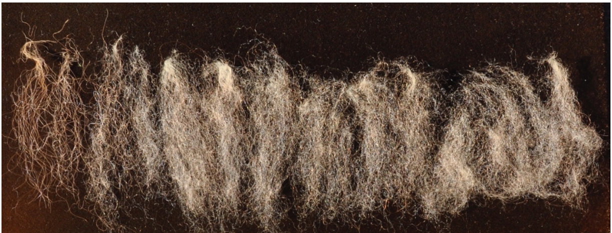
Figura 1: Fibras de una mecha DC colocadas en un paño de terciopelo según un Diagrama de Baer (Onions, 1962)
