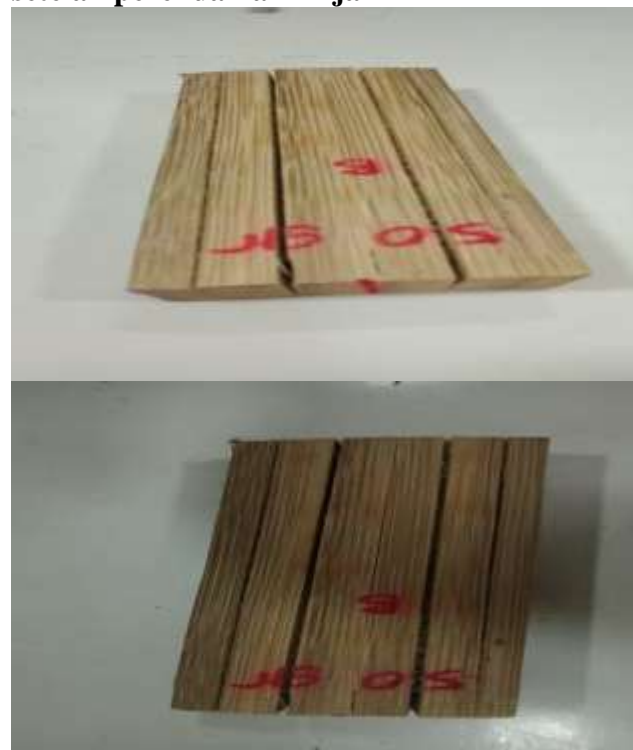
Gambar 7. Papan laminasi bambu petung mengalami peregangan pada garis perekat setelah perendaman 24 jam
