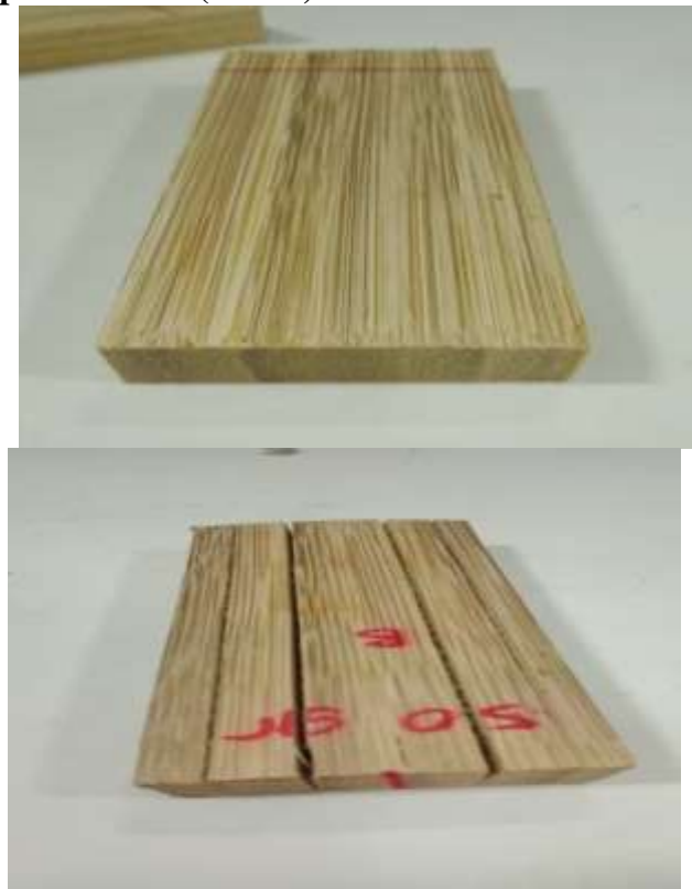
Gambar 9. papan laminasi sebelum perendaman (kiri) dan papan laminasi setelah perendaman (kanan)
