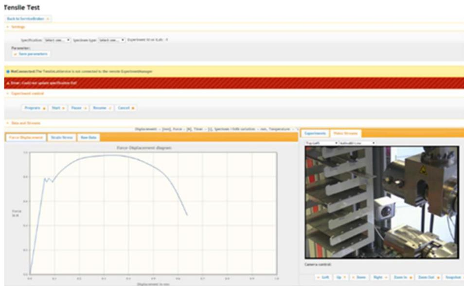
Abbildung 7: I-Lab-Interface für die Materialcharakterisierung mittels Remoteversuch
