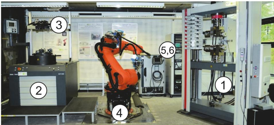
**Abbildung 2:** Automatisierte, teleoperative Prü fzelle zur Materialcharakterisierung
